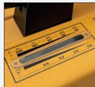
Ciclo de trabalho / diâmetro do eletrodo
