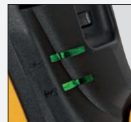
Led estado das escovas e alimentação elétrica
