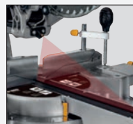
Laser de orientação do corte
