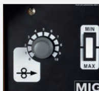
Regulador de alimentação de fio
