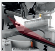
Laser de orientação do corte
