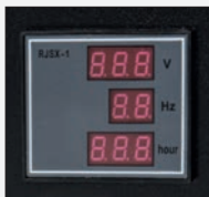
Display (tensão, frequência e contador de horas)
