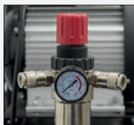
Válvulas de saída com regulação de pressão
