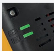
Led estado das escovas e alimentação elétrica
